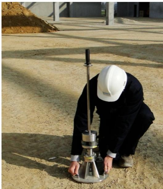
**Figure 13 : Réalisation d'un bon contact avec le sol.**
