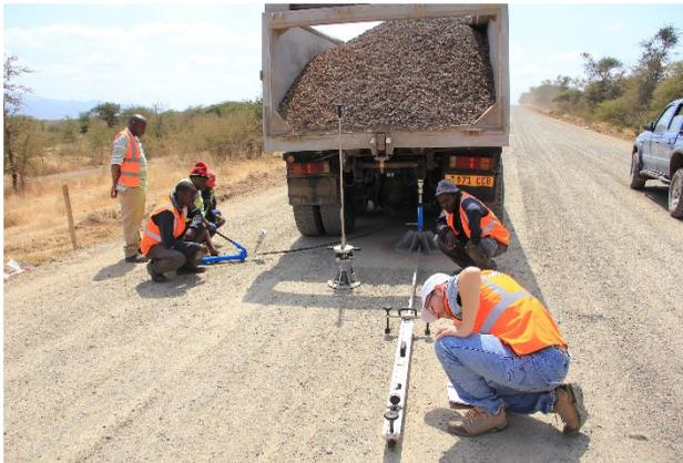
**Figure 20 : Essais de corrélation  $E_{lwd}$  et  $E_{V2}$ .**
