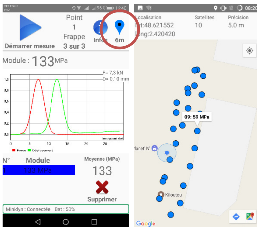
Figure 30 : Positionnement des points par GPS.
