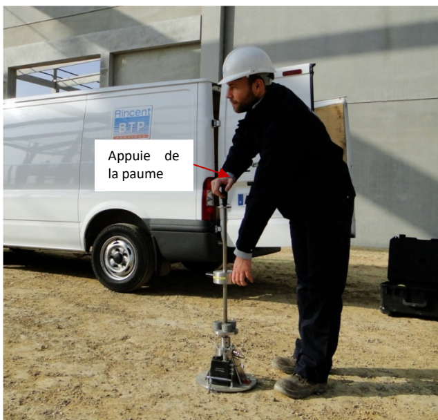
Figure 14 : Réalisation d'un lâcher.
