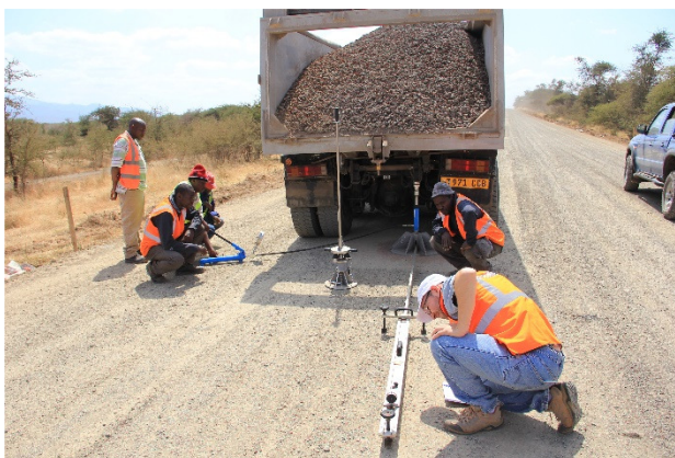
Figure 20 : Essais de corrélation E_{lwd} et E_{v2} .
