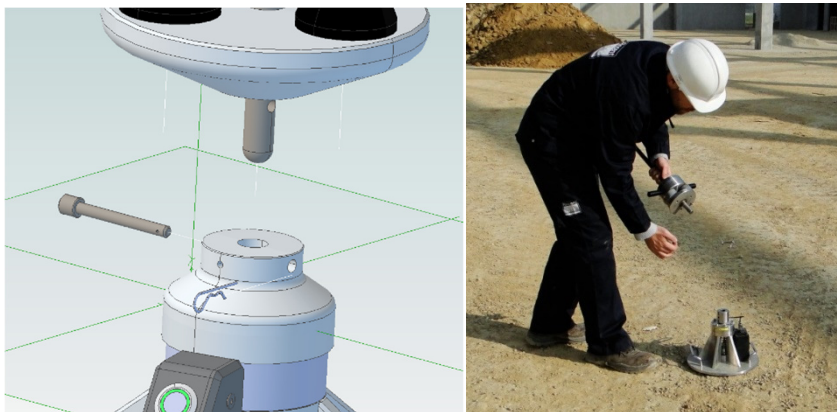
Figure 4 : Assemblage de la Minidyn à l'aide d'une goupille.
