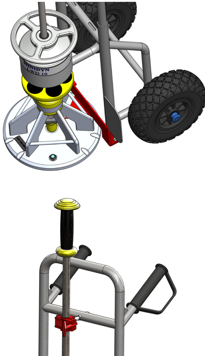
Figure 3 : Installation de la Minidyn sur le chariot
