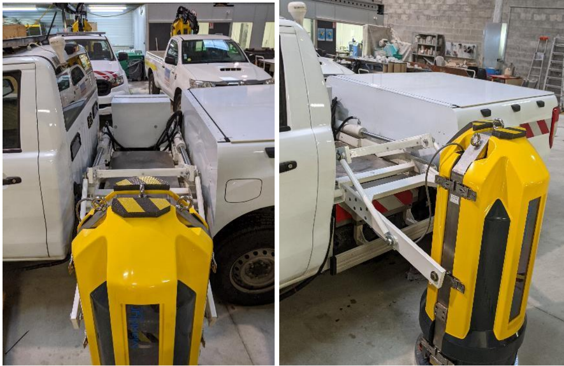
Installation du boulet dans un porteur Ranger type fourche.
