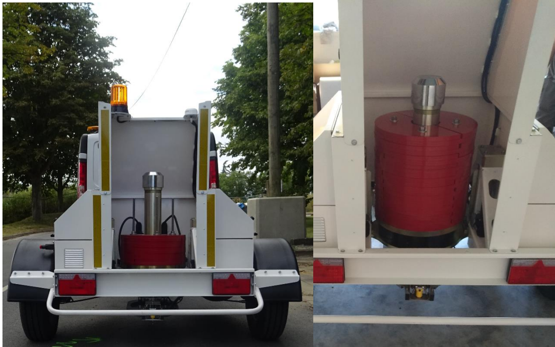
Défectomètre en configuration FWD (gauche) et HWD (droite)
