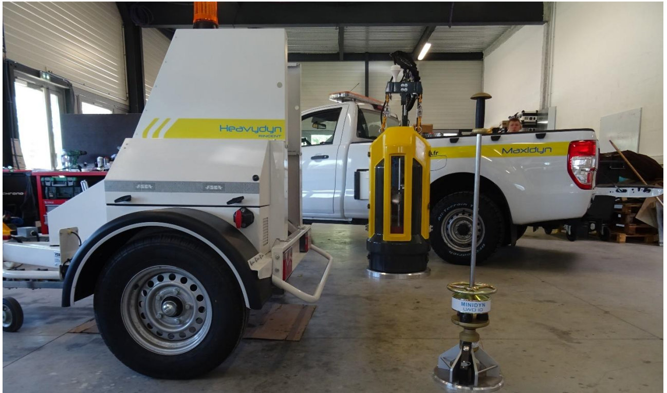
Matériels de mesure de portance fabriqués par Rincent ND Technologies
